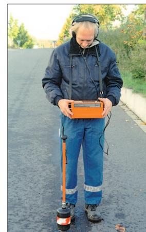
Kein Wüschelrutengänger, sondern Leckageortung am Trinkwasserversorgungsnetz. Die DNWAB ist auch für die Beseitigung von Rohrbrüchen zuständig und kontrolliert die Hydranten und Armaturen.
