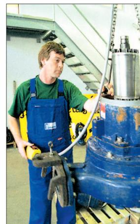
In der Pumpenwerkstatt wird eine Abwasserpumpe instand gesetzt. Die im Dauerbetrieb laufenden Aggregate unterliegen starkem Verschleiß und müssen regelmäßig gewartet bzw. repariert werden.
