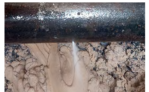
Die Leckage an diesem Rohr wurde mittels Loggertechnologie gefunden. Hier tritt – deutlich erkennbar – Wasser mit Hochdruck aus. Foto: DNWAB
